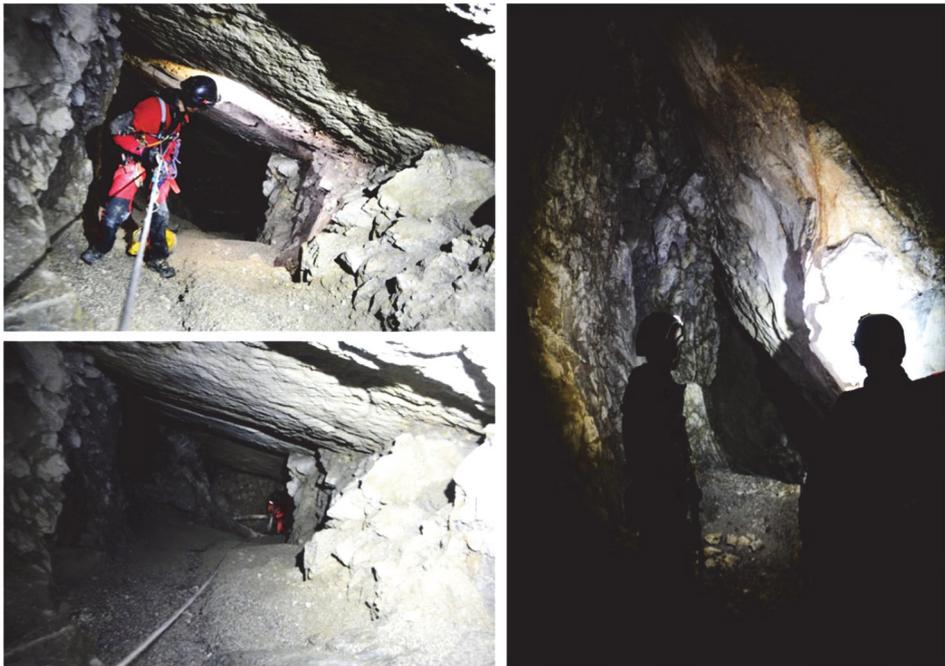
Figura 7.4. Izquierda, falso laminador excavado en estéril como rampa para transporte por gravedad. Derecha, galería.
