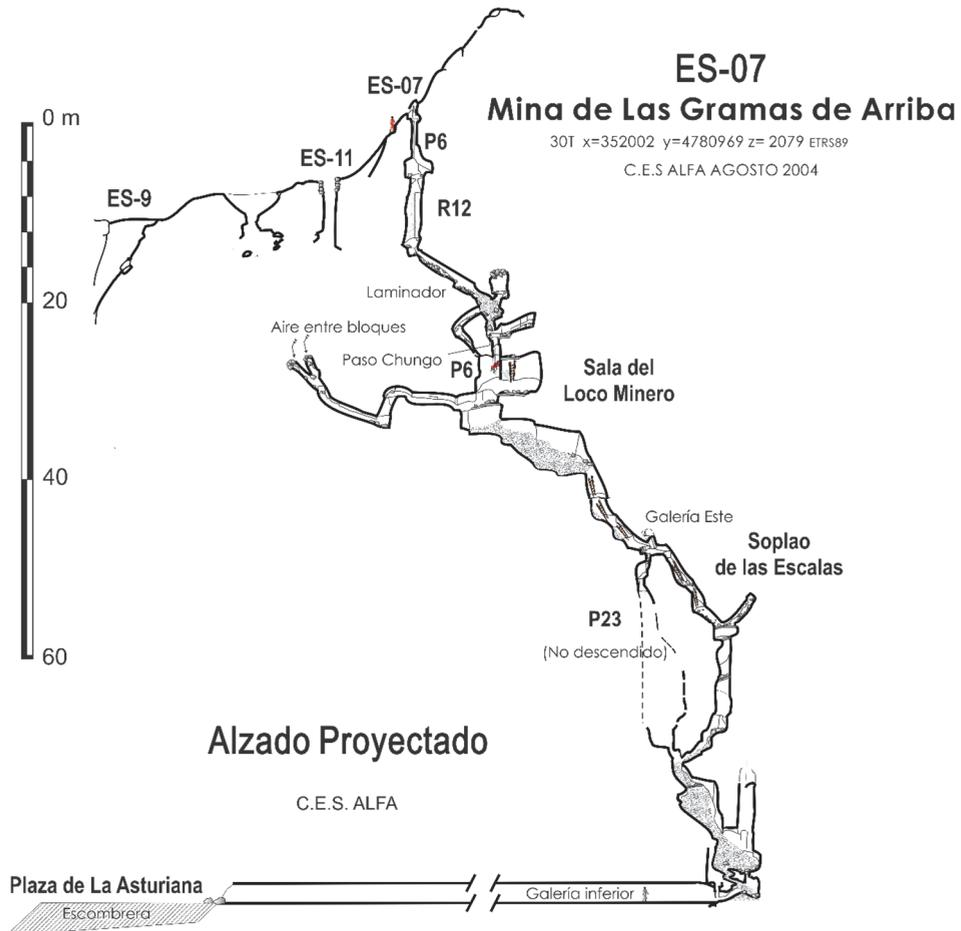
Figura 5.2. Topografía. Alzado de la mina Las Gramas de Arriba o cavidad ES7.
