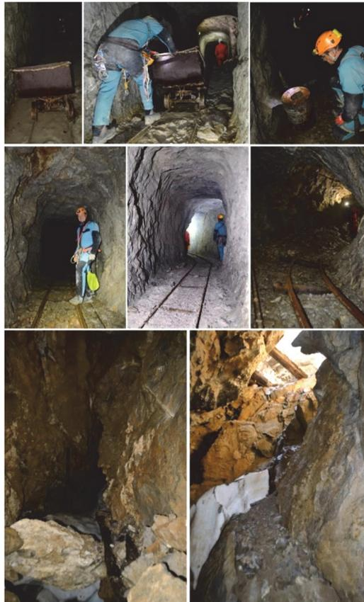
Figura 7.8. Vagonetas y galería de estériles con raíles. Abajo, izquierda, pozo de vertido hacia cavidades kársticas y a la derecha pozo de salida del mineral.
