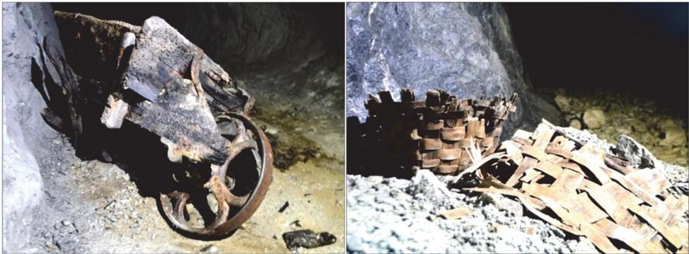
Figura 4.4. Carretilla de madera con rueda de metal y cestos para el transporte de mineral.
