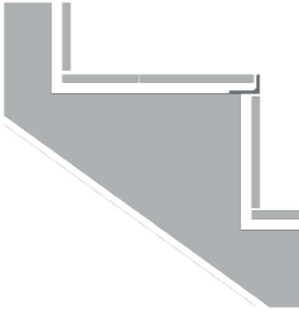
Figura 25. Detalle constructivo de los escalones de la Villa Savoye . Elaboración propia.
