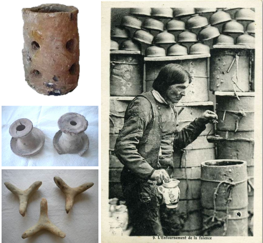
A: rulo con orificios para horno (Castilla y León); B: carretes para el horno, Portillo (Valladolid); C: palomas, caballejos o atifles de Astudillo (Palencia); D: Fábrica de Quimper (Bretaña francesa): cobijas y otras piezas en tarjeta postal, c. 1900
