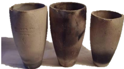
Crisoles de joyería, Brewer (París. C.P.); crisol de porcelana para laboratorio, (Alemania), (ambos utilizados en España).
